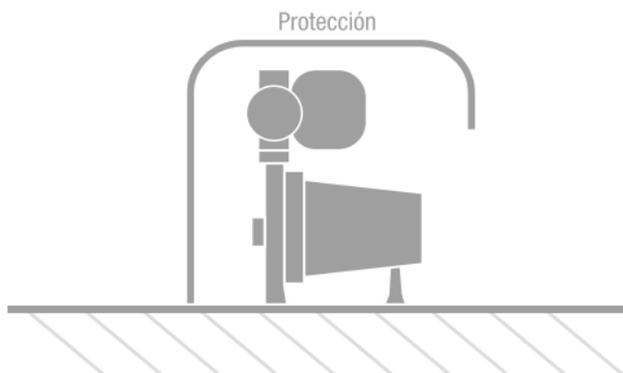
La protección de los presurizadores debe contar con ventilación para evitar la condensación (formación de agua sobre la misma). Ventilaciones deficientes provocan esta condensación, ocasionando un daño importante y una pérdida total de la garantía.
