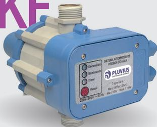
El **Controlador Automático de Presión (SKF)** activa la bomba al abrirse el paso de agua (detecta la descompresión de la cañería) y la desactiva al cerrarse el paso (presuriza nuevamente la cañería).
