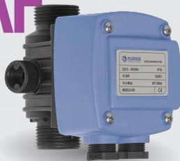
El **Controlador Automático de Flujo (CAF)** activa la bomba al detectar circulación de agua y la apaga en el instante que deja de fluir. No mantiene las cañerías presurizadas, reduciendo la probabilidad de roturas; y no se activa ante pequeñas pérdidas.
